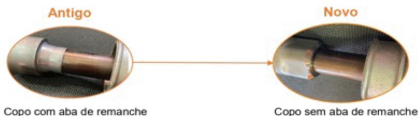
Utilizando a Solução Authomix, o reparador poderá realizar a troca da articulação axial com caixa de direção fixada ao veículo, sem a necessidade do remanche, apenas utilizando a trava química e torque recomendado pelo fabricante do veículo.
