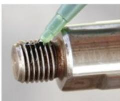
**Atenção:** A região a ser aplicada a trava química deve estar livre de impurezas e sujidades. A trava química deve ser aplicada na rosca da cremalheira de maneira uniforme e sem excessos. **Não utilize ferramentas que causem impacto no sistema de direção do veículo.**
